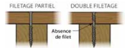
La tête de vis ne doit pas être enfoncée de plus de 1mm, au-delà le risque de fentes est augmenté.
