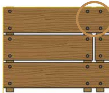
2 vis dans la largeur sous chaque point d'appui sur les lambourdes.
